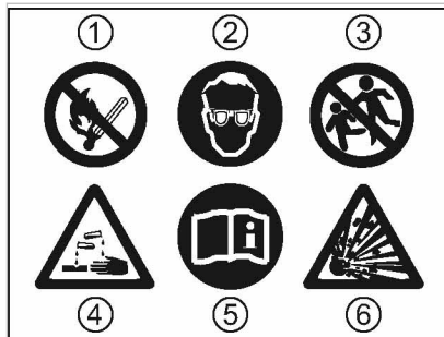
Pav. 57 Įspėjamasis lipdukas su saugos ženklais ant akumulatoriaus
